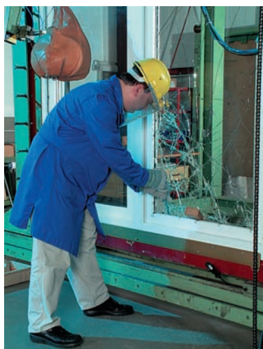
Manueller Werkzeugangriff mit Prüfer
