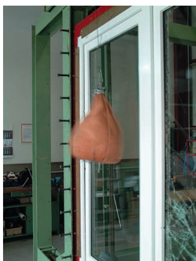
Teilansicht dynamische Prüfung
