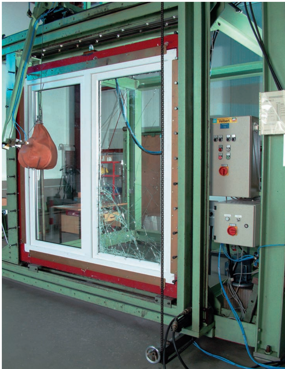
Gesamtansicht Prüfstand Einbruchhemmung
